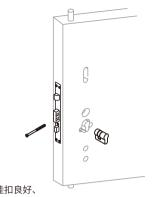
确定锁舌关门方向正确、天地杆挂扣良好、 锁头用钥匙试验其开锁顺畅。
